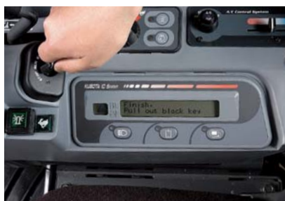
2 Insérez la nouvelle clé Noire "fonctionnelle".
