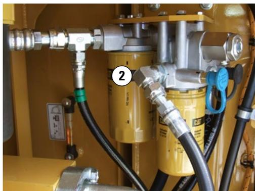
**Filtre de drainage** – Le filtre de drainage représente un niveau de protection supplémentaire contre la contamination. Monté dans le compartiment des pompes, près du filtre du circuit pilote, le filtre de drainage purifie le drain de carter des pompes principales, du moteur d'orientation et des moteurs de translation, de façon à améliorer la vie des pompes et des moteurs et à augmenter le temps de service.
